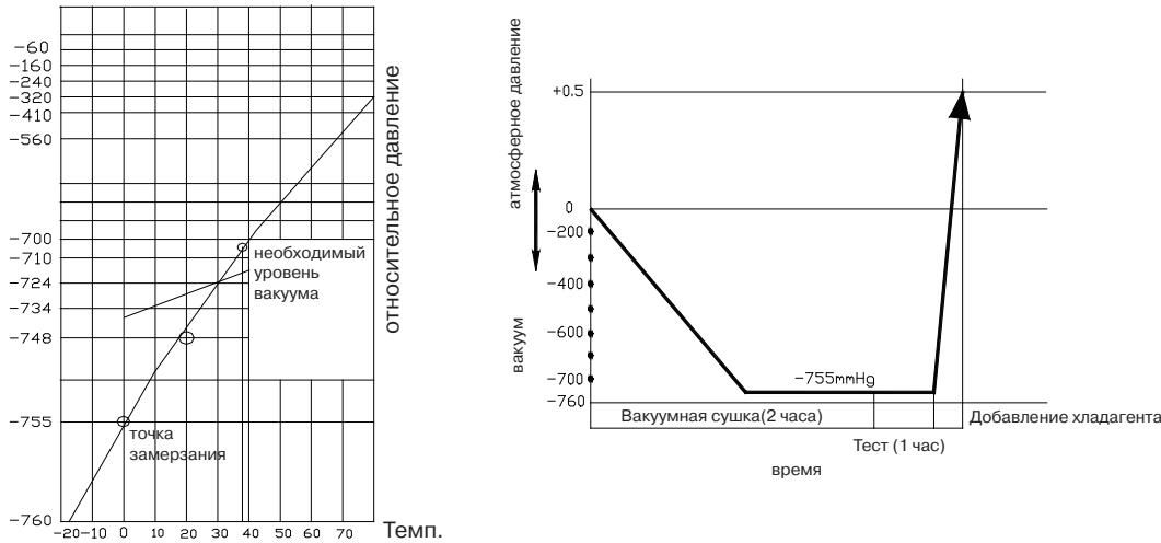
При первой установке блока на только что поставленные трубопроводы нет необходимости вакуумировать систему 2 часа, при условии, что установка трубопроводов проходила при отсутствии атмосферных осадков, и при относительной влажности воздуха не более 60%. Если установка трубопроводов проходила под осадками или при повышенной влажности, необходимо проводить вакуумирование в полном объеме.
