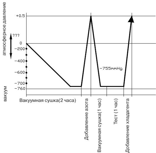
После первого вакуумирования добавьте в контур осушенный азот при давлении до 25 кг. на 30 минут. Удалите азот и снова отвакуумируйте систему. После проверки на утечку добавьте хладагент.
