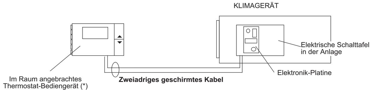
(\*) Wenn als Zusatzausstattung ein optionaler Fernsensor gewünscht wird, kann das Thermostat-Bediengerät an einer Stelle außerhalb des zu klimatisierenden Raums angebracht werden.
