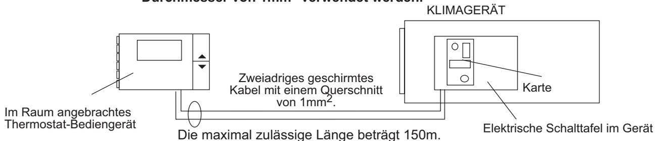
4. Schließen Sie die Kabel an die Anschlussklemmen auf der Rückseite des Gehäuses an, wie in der Abbildung und im Schaltplan dargestellt.
