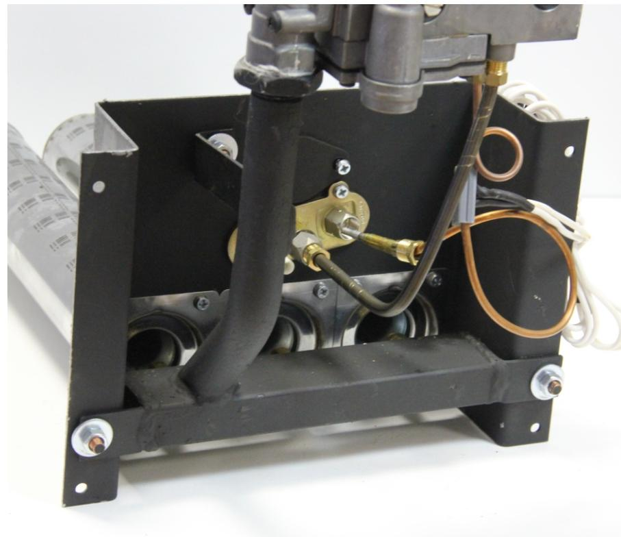
Откручиваем и вынимаем термодпару.
