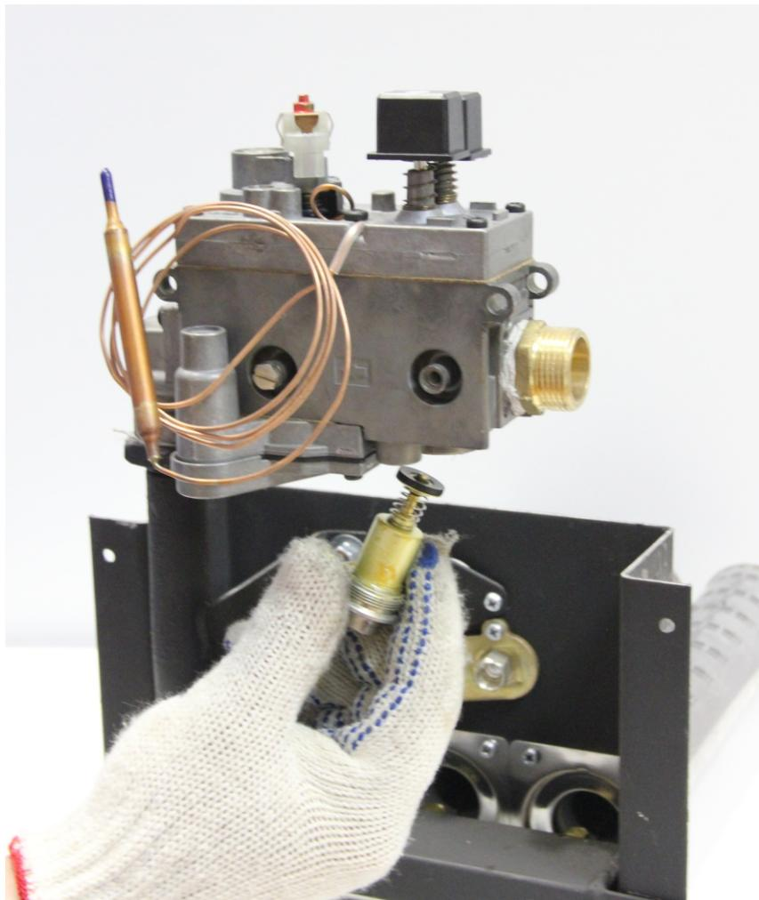
Откручиваем магнитную пробку
