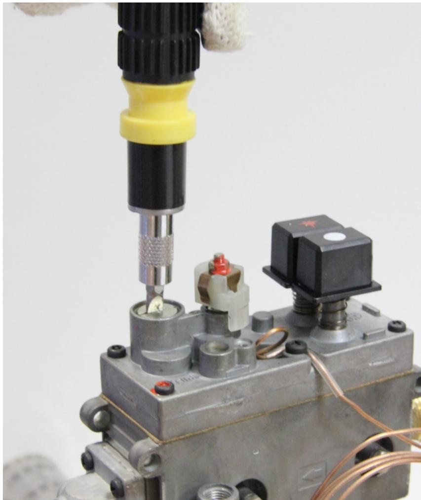
Снимаем крышку автоматики.
