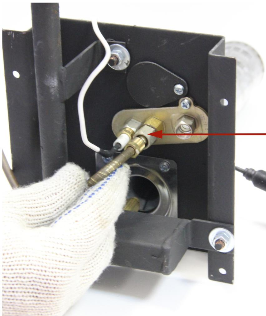
Откручиваем гайку пилотной горелки.
