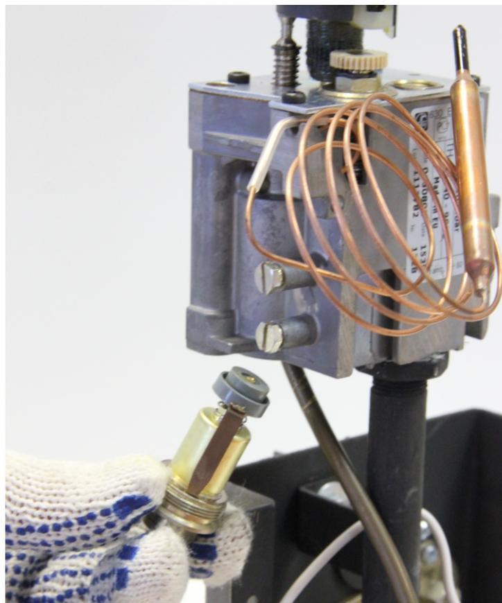
Откручиваем магнитную пробку ключом на 14.
