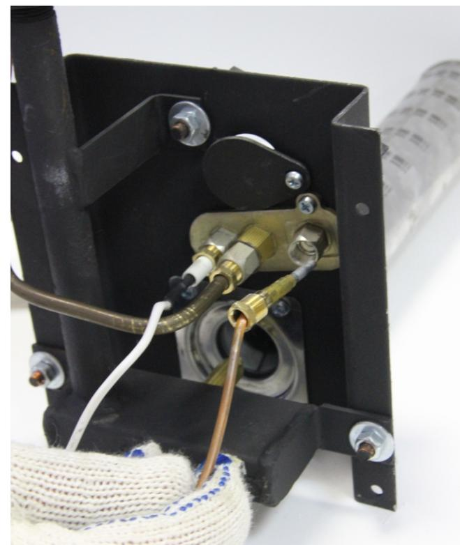
Откручиваем и вынимаем термодпару.
