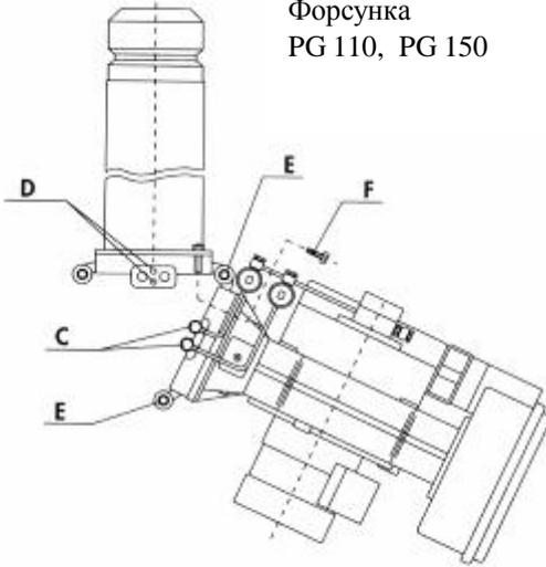
1. Снять болты соединения C;
