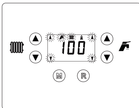
рис. 17 - Режим TEST (мощность системы отопления= 100%)
