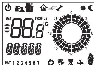
Через 10 секунд также должна отобразится и коммуникационная pictограмма, указывая на правильную работу канала по передачи данных между платой управления котельной установки и блоком ДУ.
