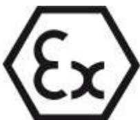
Отмеченные изображенным здесь символом разделы данного руководства по эксплуатации распространяются на взрывозащищенные насосные агрегаты, а также действительны для их временной эксплуатации вне взрывоопасных зон. Во взрывоопасных зонах разрешается эксплуатировать только насосы/насосные агрегаты, имеющие соответствующую маркировку и соответствующий допуск в техпаспорте.
