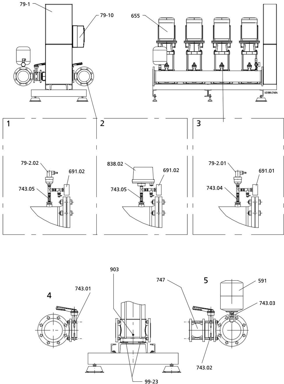
Рисунок 14: Запасные части для Hyamat VP с Movitec 32, 45, 65, 90
