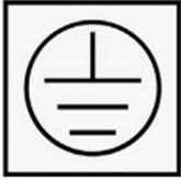
Рисунок 4: Символ заземления
