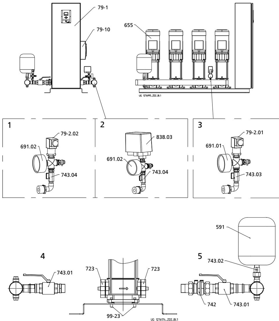
Рисунок 13: Запасные части для Hyamat VP с Movitec 2, 4, 6, 10, 18
