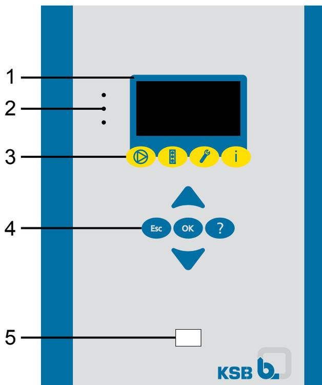
Рисунок 6: Панель управления BoosterControl Advanced
