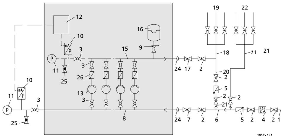
**Рисунок 15:** Технологическая схема, непосредственное подключение - части, изображенные на сером фоне, входят в комплект поставки
