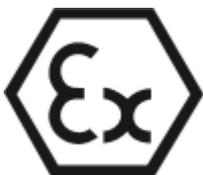
Во взрывоопасных зонах разрешается эксплуатировать только насосы/насосные агрегаты, имеющие соответствующую маркировку и соответствующий допуск в техпаспорте.
