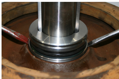
Рис. 18: Извлечение торцового уплотнения с помощью монтировок
