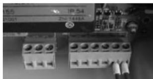
Рис. 16: Подключение внешн. тревожной сигнализации
