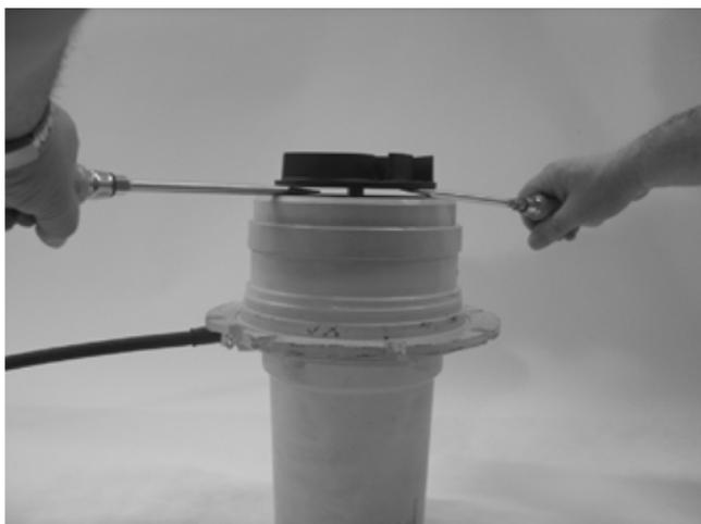
Рис. 30: Снятие рабочего колеса
