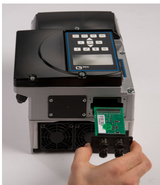
Рис. 34: Установка модуля M12
