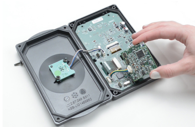
Рис. 48: Установка модуля Bluetooth
