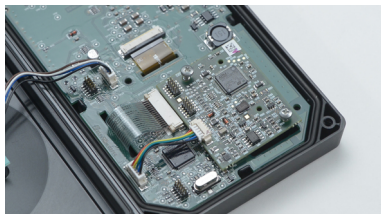
Рис. 49: Крепление модуля Bluetooth
