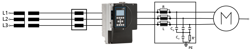
Рис. 30: Встраивание сглаживающих дросселей и выходных фильтров
