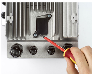
Рис. 24: Установка и крепление крышки винтами
