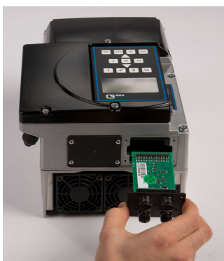
Рис. 41: Установка модуля полевой шины
