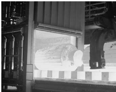
Кузнечная печь с выкатным подом в металлургической промышленности
