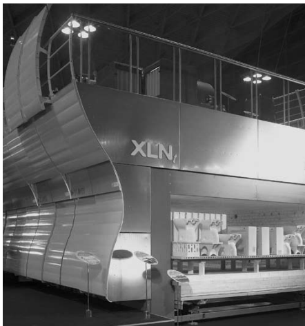
Печь с выкатным подом в керамической промышленности
