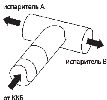
Рисунок 8.5. Схема разветвления жидкостного трубопровода
