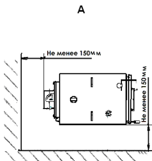
Схема установки котлов
