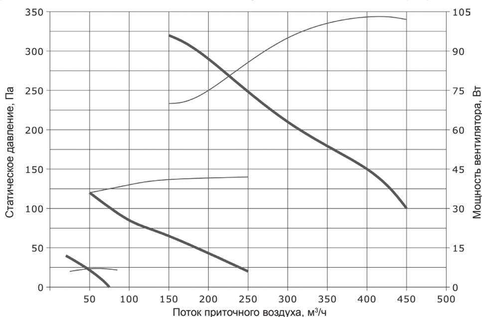
\* Коэффициент поправки вентиляционной установки RECU 400VWCF - 20 Па.
