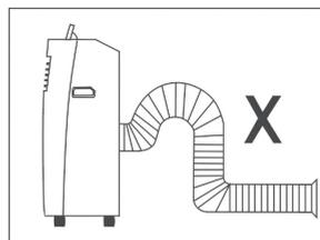
**ВНИМАНИЕ:** ИСПОЛЬЗУЙТЕ КРАТЧАЙШУЮ ВОЗМОЖНУЮ ДЛИНУ. ПРИ УСТАНОВКЕ КОНДИЦИОНЕРА РЕКОМЕНДУЕТСЯ ОБЕСПЕЧИТЬ ГОРИЗОНТАЛЬНОЕ ПОЛОЖЕНИЕ ВЫХОДНОГО ВОЗДУХОВОДА. КОГДА ОТВЕРСТИЕ НЕ ИСПОЛЬЗУЕТСЯ, ЗАКРЫВАЙТЕ ЕГО КРЫШКОЙ.
