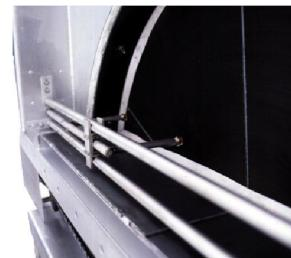
Обычно чистят с помощью сжатого воздуха и водой под давлением с температурой около 80 °C или с помощью пара.
