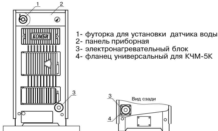
Рис.1 Установка электронагревательного блока на котле.
