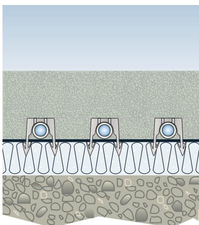
Структура пола соответствует конструктивному исполнению A1 согласно стандарту DIN 18560, часть 2.
