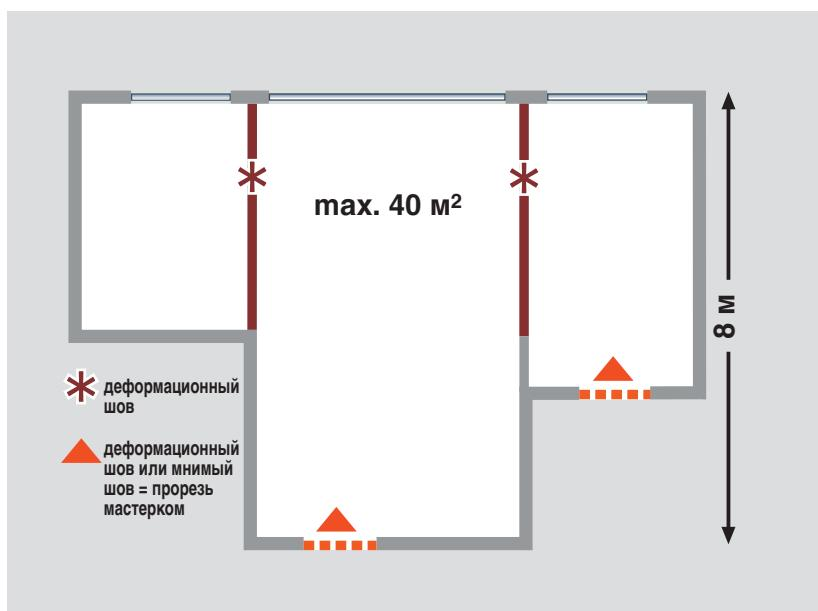
Деформационные швы полностью разделяют бесшовный пол вплоть до слоя теплоизоляции и звукоизоляции от ударного шума. Мнимые швы обеспечивают дополнительное снятие напряжений в полях бесшовных полов.
