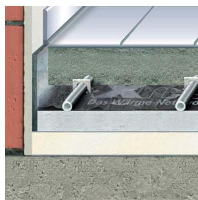
В данной ситуации (боковая изоляционная полоса и плитки) можно видеть, что только после расшивки швов можно отрезать выступающую часть боковой изоляционной полосы, так как иначе раствор для заливки швов может привести к образованию звуковых перемычек.
