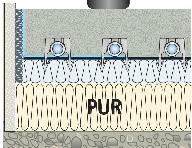
Прошивная плита системы xnet C12 NM 25-2
