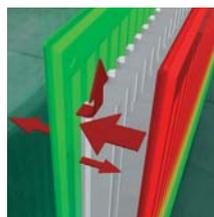
Небольшие потери на излучение на наружную поверхность. Это обусловлено более низкой средней температурой поверхности задней панели.
