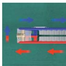
Повышение энергоэффективности и сокращение потерь при распределении и выработке тепла благодаря большей разнице между подающим и обратным трубопроводом. Прежде всего при работе в режиме неполной нагрузки при малом расходе.
