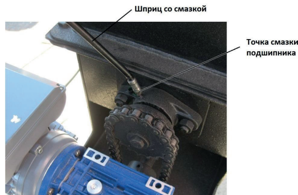
Рис. 8. Смазка подшипников шнековой подачи.
