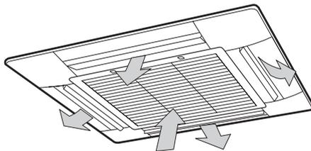
Если этот режим включен, то включается вентилятор внутреннего блока, меняя направление потока воздуха. Угол качания заслонок в каждую сторону составляет 30°. Когда кондиционер выключен или находится в режиме готовности, кнопка SWING не работает (кроме случаев, когда установлен таймер включения).
