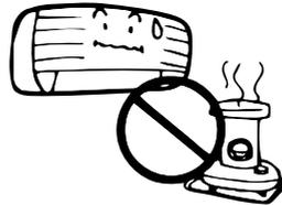
Это может привести к деформации корпуса блока под действием тепла.
