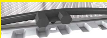
Уплотнения Кельвион идеально сочетаются с пластинами для обеспечения безотказной работы. Отверстия с развалцованными краями обеспечивают надежную фиксацию уплотнений в требуемом положении и предотвращают повреждение фиксирующего выступа. Монтаж уплотнений достаточно прост и не требует использования инструментов или клея, они автоматически занимают правильное положение во время сборки. Замена уплотнения занимает несколько секунд, что ускоряет и упрощает техническое обслуживание.
