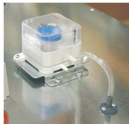
Вентблок Airblock FG с установленным дифференциальным пневматическим выключателем для фильтра
