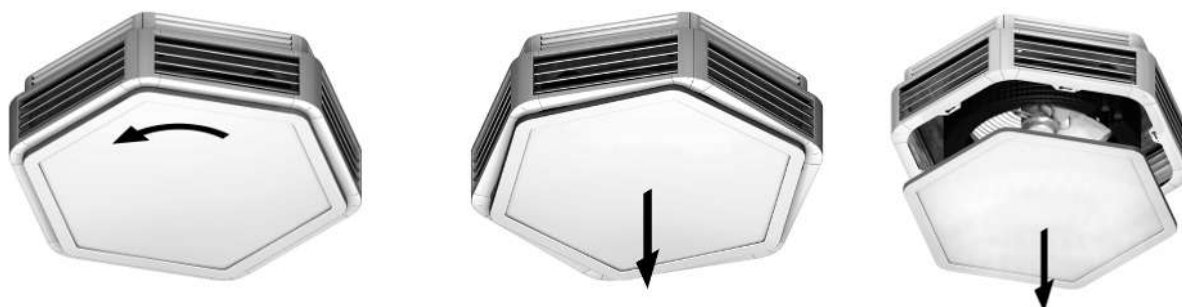
Рис. 32: Демонтаж крышки корпуса
