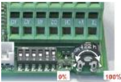
Настройки потенциометра на главной плате
