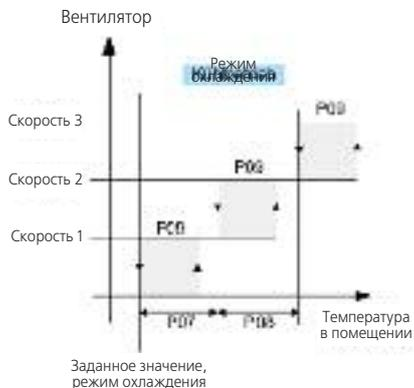
В автоматическом режиме ступени вентилятора включаются и выключаются в зависимости от регулирования температуры помещения.
