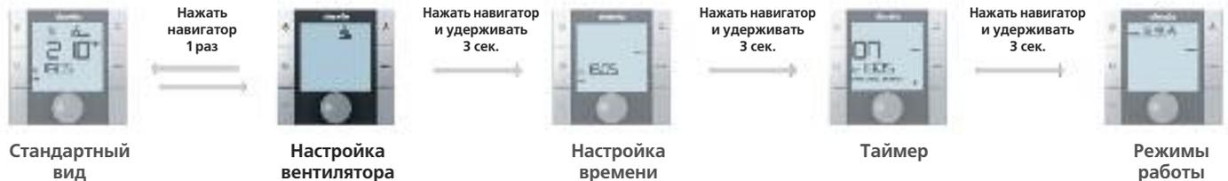
В автоматическом режиме температура помещения регулируется автоматической адаптацией скорости вращения вентилятора. Кроме того, у пользователя есть возможность установить по желанию ступени вентилятора «Автоматическая настройка 1-2-3».
