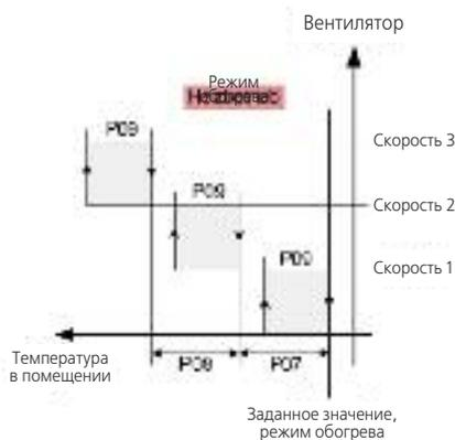
В зависимости от разницы между заданными и фактическими значениями (температуры помещения) выводятся предельные значения включения с помощью стандартных настроек скорости вентилятора:
