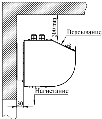
ГОРИЗОНТАЛЬНАЯ УСТАНОВКА к стене с помощью кронштейнов
