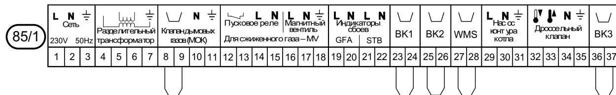
Рис.44. Колодка штекеров подключения базовой панели управления при поставке
