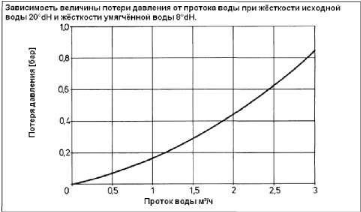
Рис. 12 Потеря давления в рабочем режиме умягчения (поз. 1).
