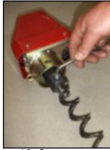
12. Заверните наружный зажимной винт.
