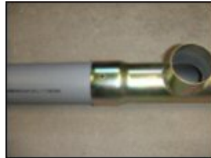
16. Выпускное отверстие пластиковой трубы должно находиться под углом 180 градусов от выпускного отверстия тройника.
