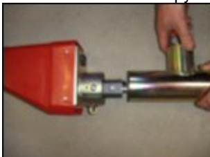
19. Наденьте трубу шнека на спираль и зафиксируйте на месте так, чтобы выпускное отверстие тройника было направлено в сторону соединения на двигателе.
