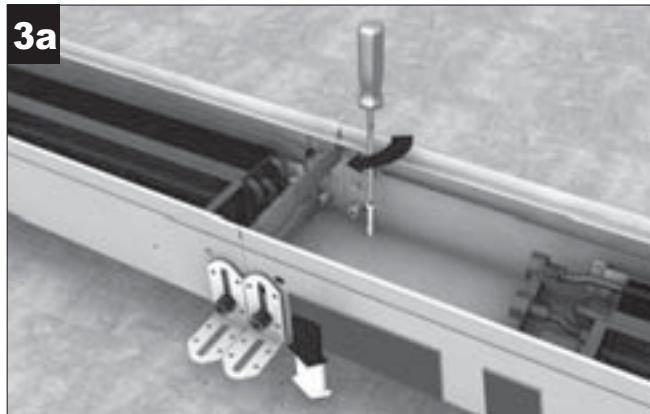
Используйте регулировочный винт для регулировки высоты Clima Canal (3a).
