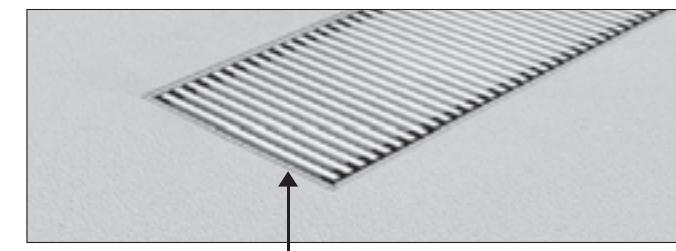
Предусмотрен эластичный уплотнитель для заделки шва.
