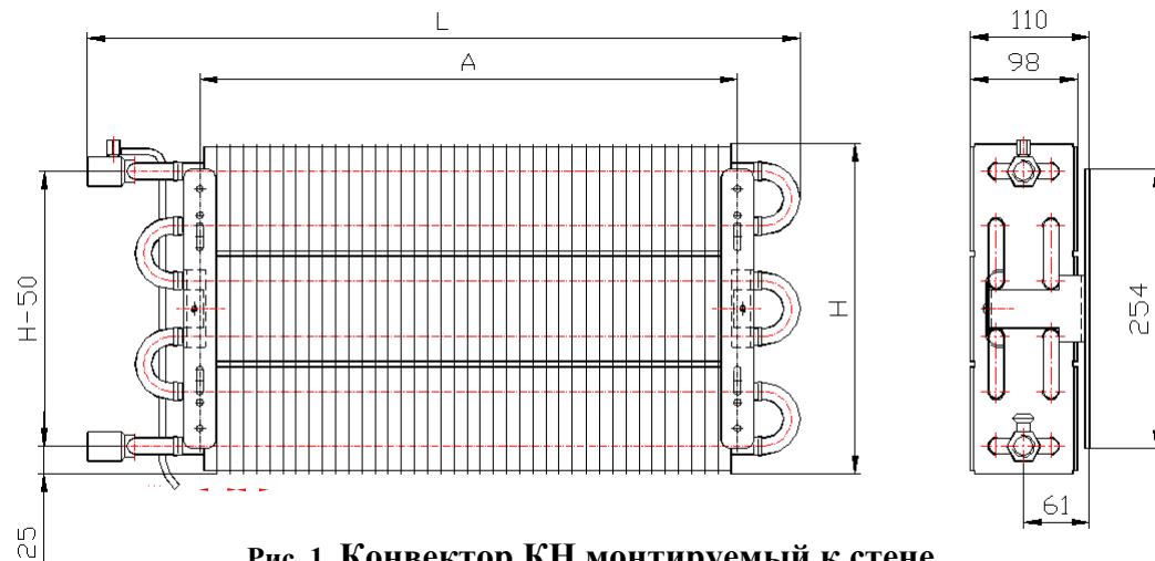
Рис. 1 Конвектор КН монтируемый к стене.
