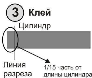
Отрезать от клеевого цилиндра, поставляемого в комплекте, 1/15 часть (приблизительно) от его общей длины. Отрезанную массу хорошо размять!!! в течение (не более)!!!! 1 мин. пальцами руки. Затвердевание клея происходит в результате химической реакции, возникающей при перемешивании двух компонентов клея. На цилиндрическом срезе оставшегося клеевого цилиндра вы можете увидеть двойное строение его составляющих. Чем лучше будет перемешана необходимая смесь, тем качественней будет клеевое соединение.
