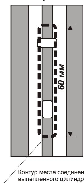
Выпиленный цилиндр из клеевой смеси прикрепить на внешнюю часть задней стенки Допримо, как показано на рисунке. Место соприкосновения стенки с клеем желательно заранее обезжирить спиртом.
