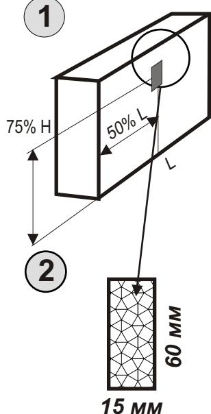
Крепёж распределителя к радиатору производится на обозначенное на схеме место крепежа независимо от способа его крепления Н (закрутка, сварка, склеивание).
