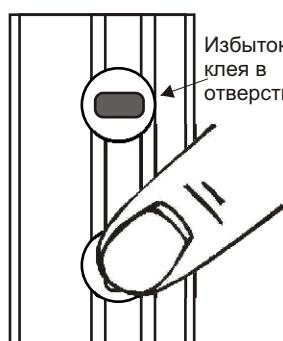
После прижатия задней стенки распределителя к поверхности от. прибора, в отверстиях крышки появляется избыток клея.
