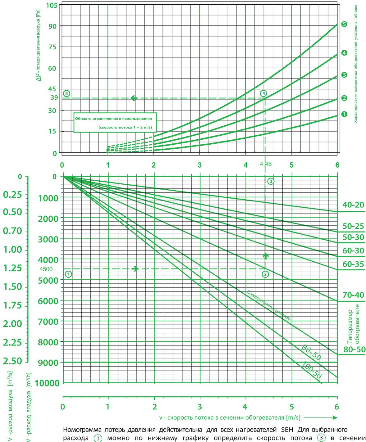
Номограмма потерь давления действительна для всех нагревателей SEN. Для выбранного расхода ① можно по нижнему графику определить скорость потока ③ в сечении нагревателя ②, а в последствии для известной скорости можно в верхней части ④ установить соответствующую потерю давления воздуха ⑤.
