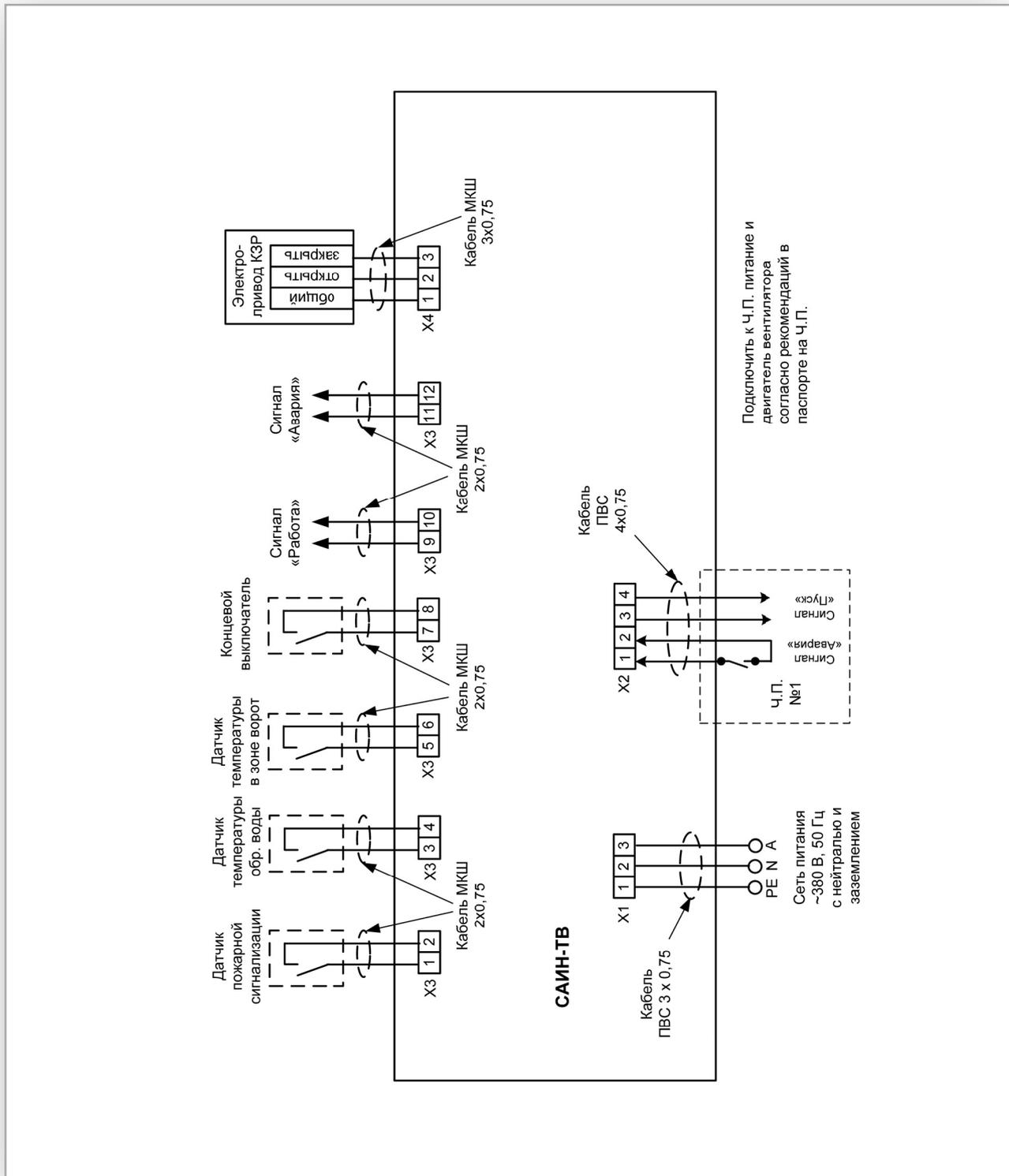
Система управления тепловой завесой с водяным калорифером и запорным вентилем САИИ-ТВ
