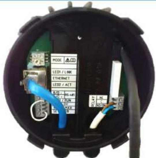
**ПРИМЕЧАНИЕ:** Для обеспечения соответствующей степени защиты насоса IP сетевой кабель нужно протянуть через входной сальник, а затем присоединить к разъему.
