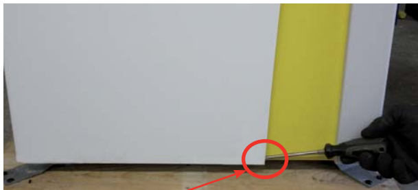
Відкрийте за допомогою викрутки
