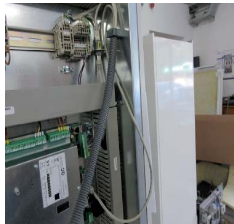
LAN-кабель можна помістити у кабельний канал
