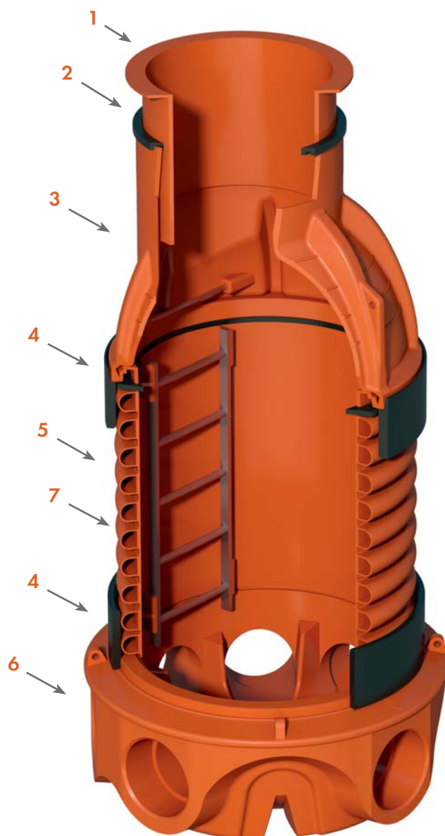
Рис. 1.3. Сборный полимерный колодец DN/ID 1000 мм с телом ID1000 ИКАПЛАСТ
