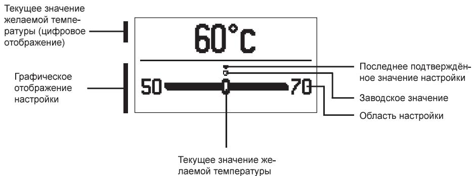
Нажатием клавиш **-** и **+** устанавливается желаемая температура и подтверждается нажатием клавиши **✓**. Для выхода из настройки нажмите клавишу **↖**.
