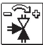
Выберите направление открытия смесительного клапана с помощью клавиш **-** и **+**. Подтвердите выбранное направление нажатием клавиши **✓**.
