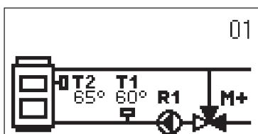
Выберите гидравлическую схему для работы сервопривода. Перемещение в меню по схемам осуществляется с помощью клавиш **—** и **+**. Выбранную схему подтвердите нажатием клавиши **✓**.
