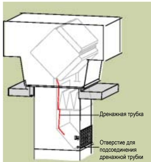
Рис. 1: Конструкция агрегата
