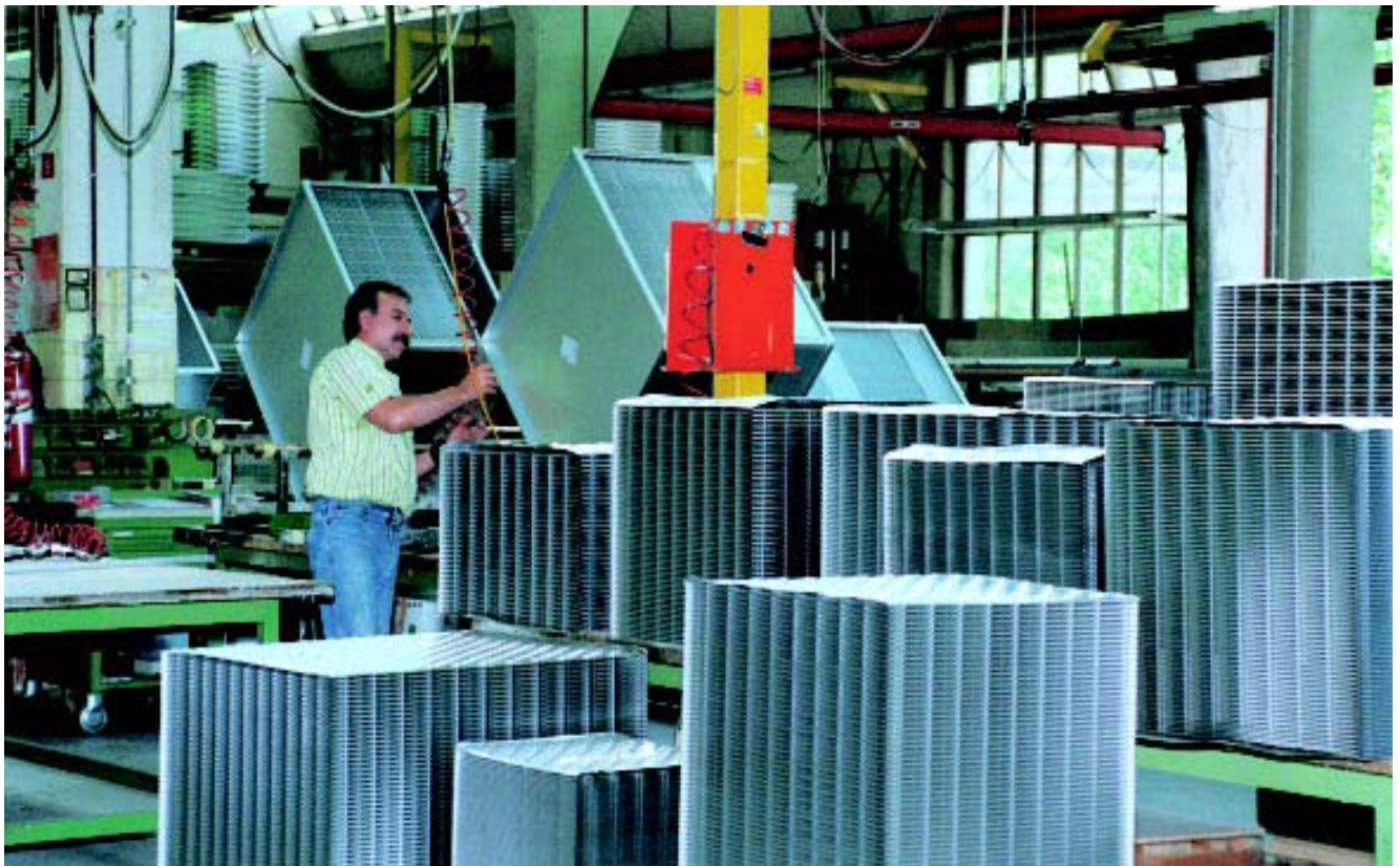
Рис. 20: Блок теплообменника плотно устанавливается внутрь корпуса
