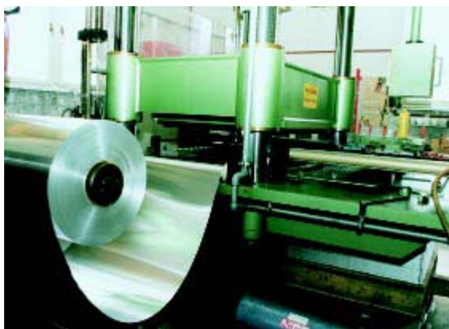
Рис. 13: Штамповка пластин для теплообменников типа N на автоматизированных прессах
