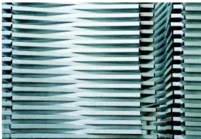
Рис. 25: Боковые панели, изготовленные из листовой стали с покрытием Aluzinc, подготовлены к сборке
