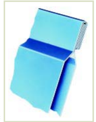
Рис. 16: Посредством двойной фальцовки достигается прочное соединение пластин
