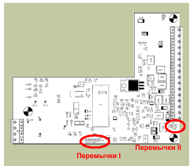
Рис. Для перестановки переключек групп I и II снимите крышку с блока управления
