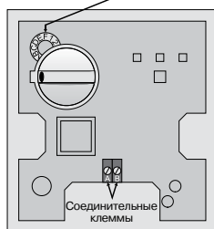
Поворотный диск с 16-ричным кодом (для настройки адреса шины)
