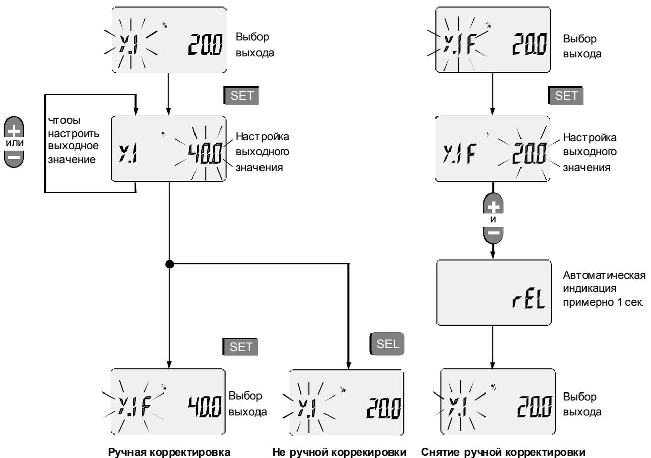
Рис. 10. Настройка выходного значения при ручной корректировке
