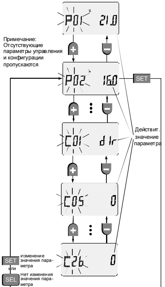
Рис. 7. Режим выбора параметров/ конфигурации
