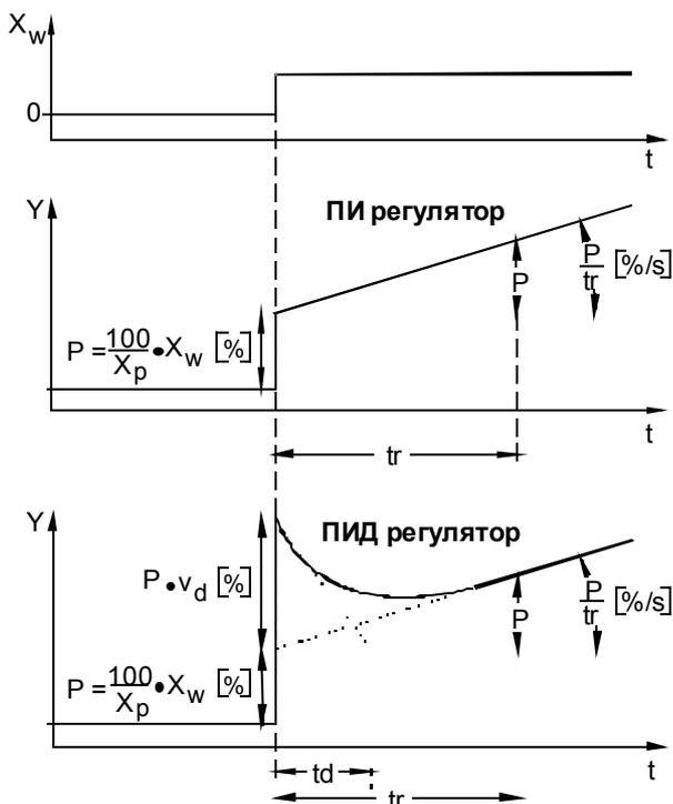
Рис. 3. Переходная характеристика ПИ и ПИД регулирования
