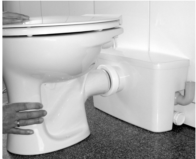
(Abb. 1) Stellen Sie das WC vor die Kunststoffbox und schieben Sie den WC-Stutzen in die Verbindungsmanchette der Anlage. Achten Sie unbedingt darauf, dass der Behälter der Saniflux nicht eingedrückt wird.
